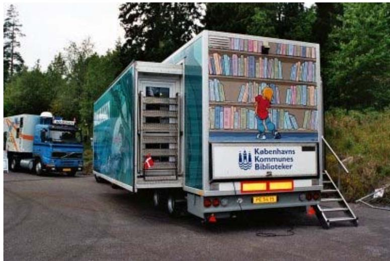
14. Reboque, com módulo retrátil em posição distendida (Copenhaga - Dinamarca).
